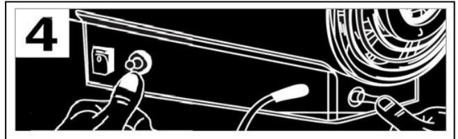
11. Warten Sie, bis der Lüfter ruhig und stabil läuft. Drücken Sie mit Ihrer rechten Hand 10 Sekunden lang den Knopf des Gasventils. Drücken Sie gleichzeitig mit der linken Hand mehrmals auf die Zündung, um das Gerät zu zünden (Abb. 4).
